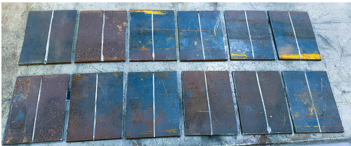
Figura 1 – Chapas de aço preparadas para soldagem
