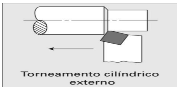
Figura 1: Processo de torneamento cilíndrico externo. Será o método adotado neste estudo.
