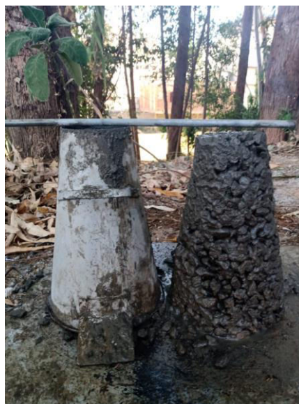
Figura 1: Slump test do concreto convencional Fonte: Arquivo Pessoal (2022)
