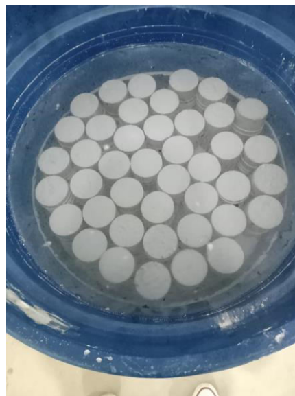
Figura 4: Cura dos corpos de prova Fonte: Arquivo Pessoal (2022)
