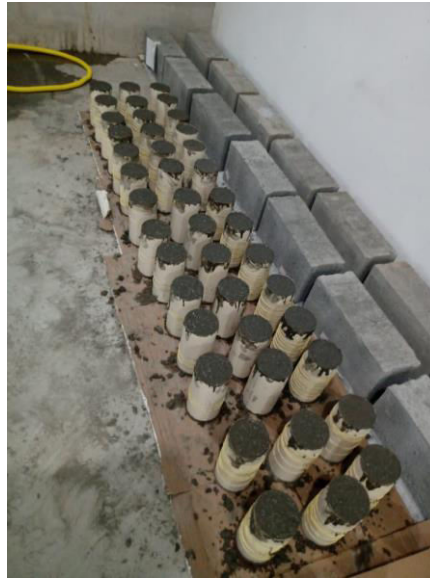
Figura 3: Moldagem e identificação dos corpos de prova Fonte: Arquivo Pessoal (2022)
