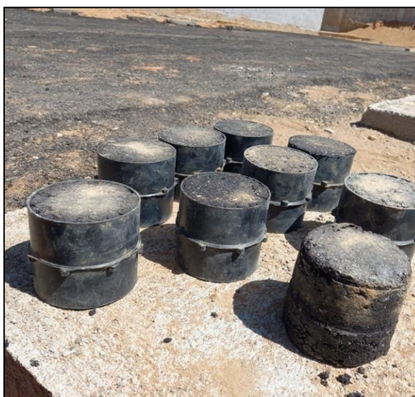
Figura 1: Execução da moldagem dos Corpos de Prova Fonte: Arquivo Pessoal do Autor.
