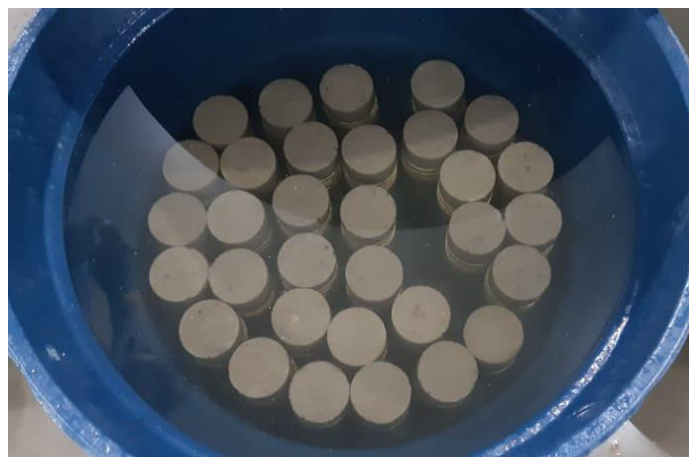
Figura 2: Cura dos corpos de prova. Fonte: Os autores (2020).
