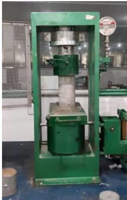
Figura 3: Ensaio de resistência à compressão axial utilizando a prensa hidráulica. Fonte: Os autores (2020).
