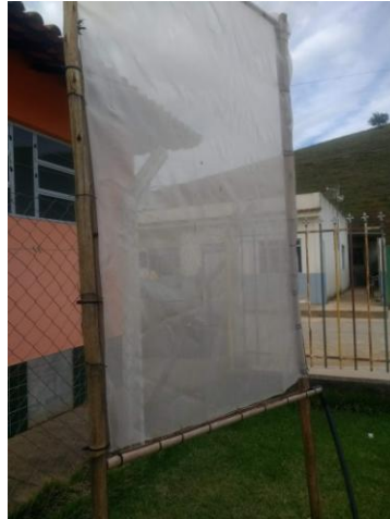
Figura 9: Atrapaniebla depois de ser modificado a tela em Sericita MG. Fonte: Acervo particular dos autores (2018).
