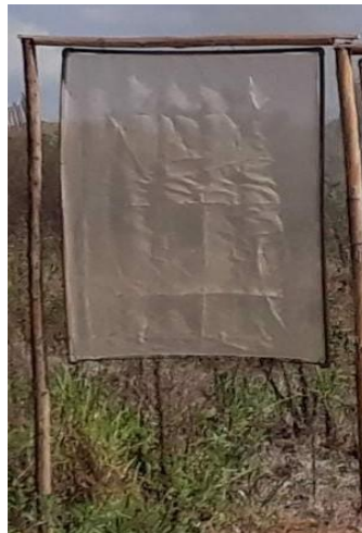
Figura 10: Atrapaniebla depois de ser modificado a tela em Matipó MG. Fonte: Acervo particular dos autores (2018).
